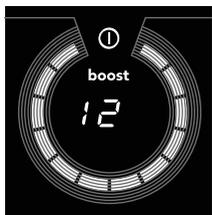
Режим Boost используется для приготовления пищи на максимальной мощности за короткий период времени (максимум 10 мин). По истечении максимального времени нагнетания мощность уменьшается до уровня 12.
