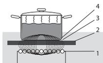
Катушка (1) в плите (2) генерирует магнитное поле (3). После установки посуды с железным дном (4) на катушку в дне посуды возбуждается ток.
