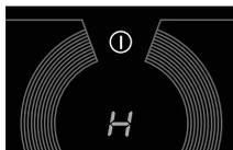
После использования конфорка может оставаться горячей в течение еще нескольких минут. Пока конфорка остается горячей, на дисплее высвечивается символ «H».
