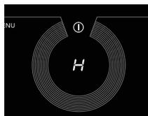
После использования конфорка вок может оставаться горячей в течение еще нескольких минут. Пока конфорка остается горячей, на дисплее высвечивается символ «H».
