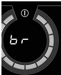
1. Чтобы выключить функцию моста, нажмите кнопку моста на ползунке регулятора передней конфорки и удерживайте ее две секунды.
