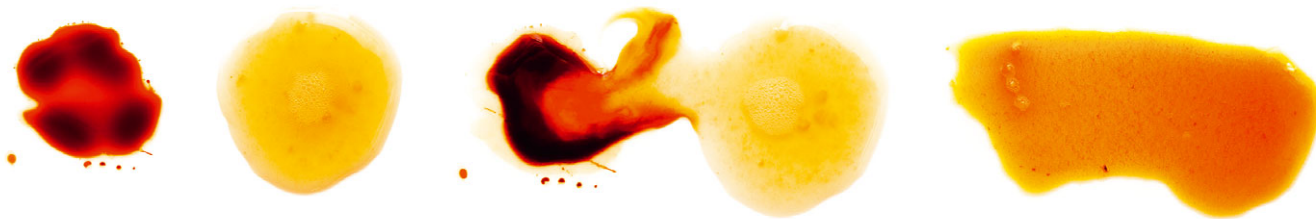
ФОТО 5. Для того чтобы проверить, весь ли крахмал расщеплен на сахара, обычно используют простейшую йодную пробу. Если при соединении капли сусла с каплей йода не происходит окрашивания в синий цвет, значит, крахмала в сусле больше не осталось
