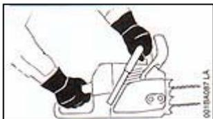
ручке – это действительно также для левши. Для надежного ведения мотопилы трубчатую рукоятку и ручку схватить плотно большим пальцем.
