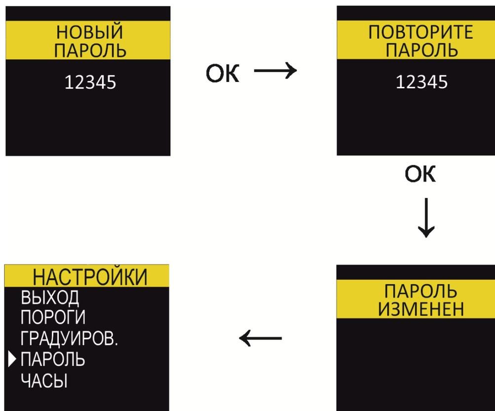
Рисунок 10. Дисплей в режиме "ПАРОЛЬ"
