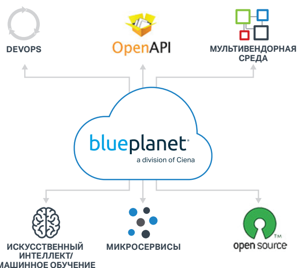
Рис. 2. Blue Planet использует контейнерную микросервисную программную архитектуру, включающую компоненты с открытым исходным кодом с расширенным моделированием и методиками DevOps для реализации открытой высокопрограммируемой программной платформы.
