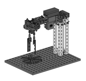
В модели мешалки используется сочетание конического редуктора и планетарной передачи. Соберите эту модель в соответствии с руководством по сборке.
