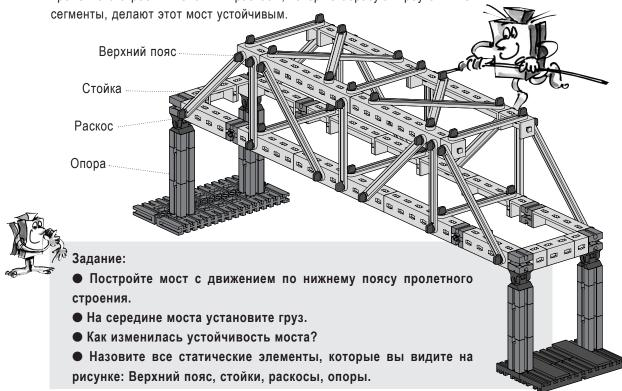
Эта модель может выдерживать очень большие нагрузки. В ней сжимающее усилие передается не только на балку, но и распределяется на дополнительные элементы конструкции. Верхний пояс состоит из перекрещенных раскосов, прикрепленных к верхним узлам боковых элементов. Раскосы на верхней балке не дают мосту перекашиваться.
