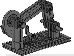
► Четырехзвенный механизм, как подразумевает его название, состоит из четырех шарниров (подвижное соединение частей, через которое происходит вращение). Упрощенная схема четырёхзвенного механизма показывает, как он работает. Вам знакомы составные части этого механизма?
