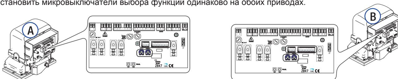
4) Выполнить подключения между блоками управления двух приводов, как показано на рисунке.
