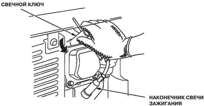
3. Осмотрите свечу зажигания. Замените свечу, если на электродах имеются следы износа или трещины и сколы на изоляторе.
