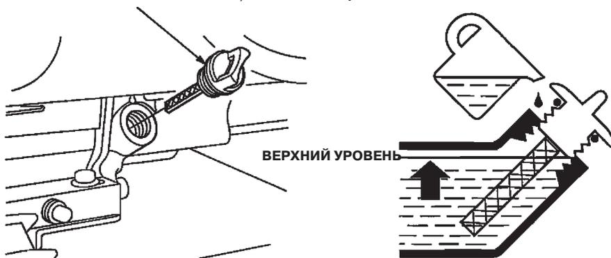
Система предупреждения о падении давления масла автоматически выключает двигатель, прежде чем давление масла упадет ниже минимально достаточного предела. Во избежание непредвиденных остановок двигателя регулярно проверяйте уровень моторного масла.
