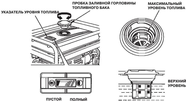
Заправку топливного бака следует производить на открытом воздухе или в хорошо проветриваемых помещениях при неработающем двигателе. Если двигатель перед этим работал, дайте ему остыть. Заправляйте топливный бак осторожно, чтобы избежать пролива бензина.
