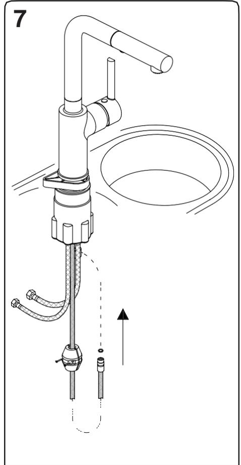
Затяните все части соответствующим образом. Подсоедините шланги к водозабору. Соедините конец гибкой подводки с коротким соединением шланга смесителя. Соберите противовес.
