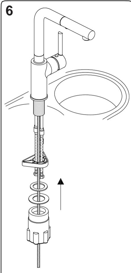
Снизу раковины соберите основание крепления, кольцо поддержки, шайбу и винт поддержки, затем затяните.
