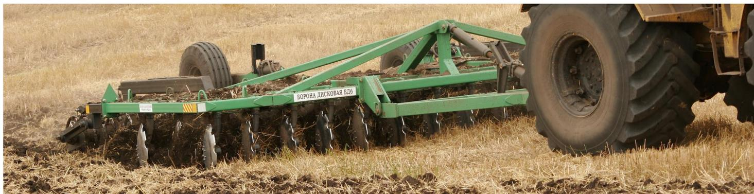
Борона дисковая «Агродиск» состоит из рамы, с закрепленными на ней рабочими органами, шасси, прицепного устройства, механизмов регулировки угла атаки дисков, центрального прикатывающего шлейф-катка, прикрепленного к раме с помощью собственных балок.
