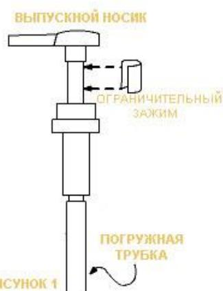
В прилагающемся к насосу пластиковом пакете находится несколько ограничительных зажимов. Эти зажимы предназначены для ограничения количества выходящего раствора HI-FLOAT. Зажимы подбираются следующим образом: Наденьте зажим на плунжер насоса, как показано на Рис. 1. Сдвиньте зажим к верхней части плунжера. При изменении размера шара зажим можно снять и заменить на новый.
