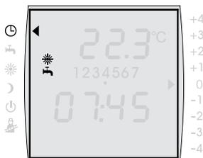
Через несколько секунд дисплей переключается на базовую индикацию. На индикаторе состояния мигает символ **Режим отопления** ☀.
