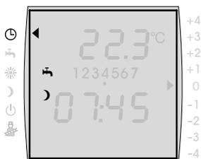
Через несколько секунд дисплей переключается на базовую индикацию. На индикаторе состояния мигает символ **ГВС**
