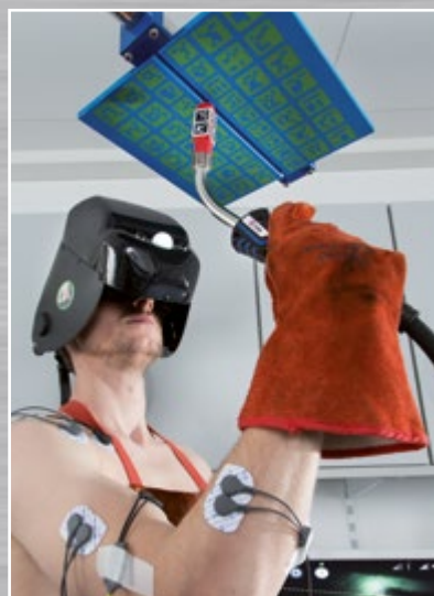
MB EVO PRO 36 в сварочной позиции PE (потолочная сварка).
