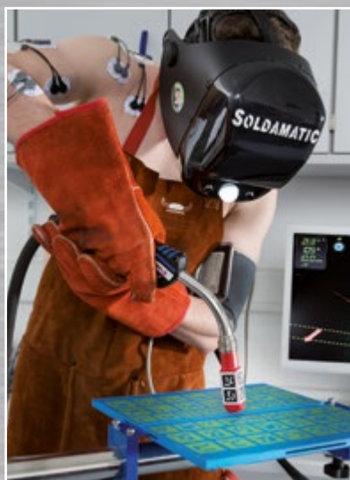
MB EVO PRO 36 в сварочной позиции PA (горизонтальная сварка стыковых и угловых швов).
