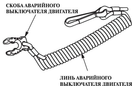
Линь аварийного выключателя двигателя предназначен для остановки двигателя в экстренных ситуациях: при падении водителя за борт или потери возможности управления. Двигатель останавливается, как только скоба, закрепленная на конце аварийного линя, извлекается из-под кнопки аварийного выключателя двигателя.
