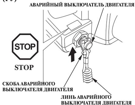
7. Вставьте скобу, расположенную на конце аварийного линия, под кнопку аварийного выключателя двигателя. Другой конец аварийного линия должен быть надежно прикреплен к запястью судоводителя.
