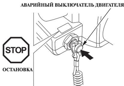
Для остановки двигателя нажмите на аварийный выключатель двигателя.
