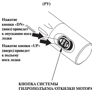
Нажимая на кнопки управления системой гидроподъема («UP» (вверх) или «DN» (вниз)), установите оптимальный угол наклона мотора, который соответствует условиям движения лодки.
