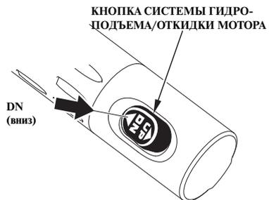
1. Нажмите на кнопку «DN» (вниз) системы гидроподъема подвесного мотора и установите мотор в самое нижнее положение.
