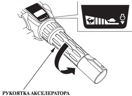
Частота вращения вала двигателя регулируется поворотом рукоятки по часовой стрелке или против нее. При повороте рукоятки по стрелке, изображенной на иллюстрации, частота вращения двигателя будет увеличиваться.
