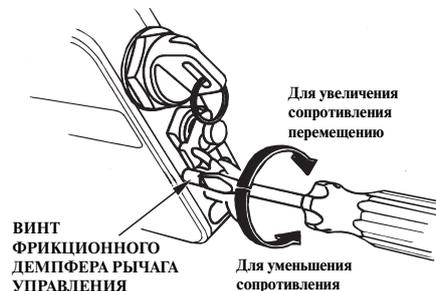
Проверьте плавность перемещения рычага дистанционного управления. Сопротивление перемещению рычага управления можно отрегулировать вращением винта фрикционного демпфера по или против часовой стрелки.
