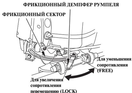
Проверьте плавность перемещения румпеля. Для того, чтобы сделать управления плавным, поверните регулятор таким образом, чтобы почувствовать легкое сопротивление при повороте.
