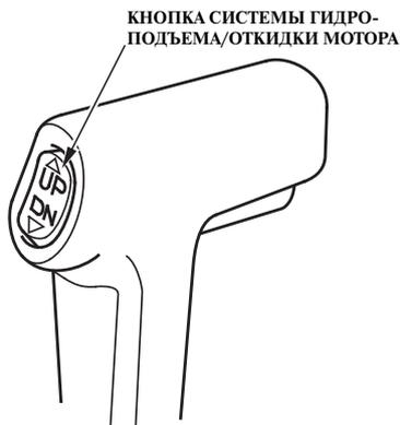
КНОПКА СИСТЕМЫ ГИДРОПОДЪЕМА/ОТКИДКИ МОТОРА
