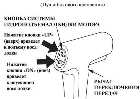
Гидропривод системы гидроподъема подвесного мотора функционирует при нажатой кнопке и отключается при ее отпускании. Для точной регулировки угла наклона мотора нажмите и сразу же отпустите кнопку «UP» (вверх) или «DN» (вниз).
