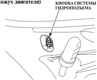
Если вы находитесь на удалении от поста управления и не можете воспользоваться органами управления, расположенными на нем, то поднять подвесной мотор можно при помощи кнопки системы гидроподъема, которая находится сбоку на подвесном моторе. Процесс управления подъемом мотора при помощи этой кнопки аналогичен подъему мотора при помощи кнопки, расположенной на пульте дистанционного управления.
