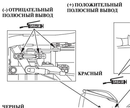
3. Присоедините клемму красного провода к положительному полюсному выводу батареи (+), затем присоедините клемму черного провода к отрицательному выводу батареи (-). Надежно затяните болты и гайки. Нанесите на клеммы и выводы аккумуляторной батареи защитную пластичную смазку.
