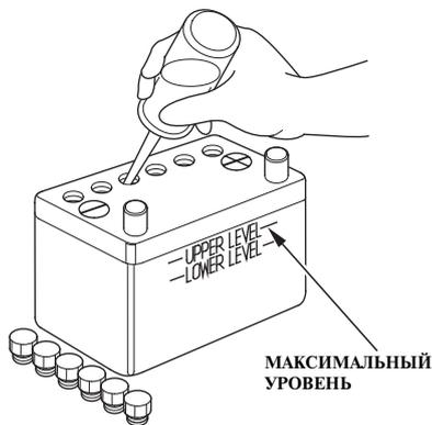
3. Долейте в аккумуляторную батарею дистиллированной воды и доведите уровень электролита до верхней метки. Запрещается превышать максимальный уровень электролита, соответствующий верхней метке.
