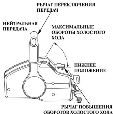
Осуществить перемещение рычага повышения оборотов невозможно до тех пор, пока рычаг дистанционного управления не установлен в нейтральное положение. И наоборот, рычаг дистанционного управления не будет перемещаться, если рычаг повышения оборотов не установлен в нижнее положение. Плавно опустите рычаг повышения оборотов, чтобы уменьшить частоту холостого хода двигателя.
