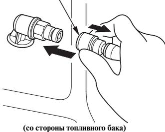
Штуцеры топливпровода предназначены для соединения топливного бака с подвешенным мотором.
