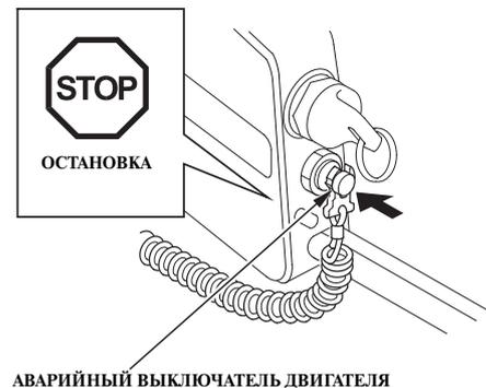
Для остановки двигателя нажмите на аварийный выключатель двигателя.
