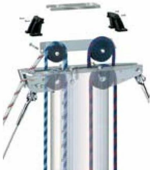
*Снимите все основания приборов и сепаратор шкива. Поднимите наружу шкивы для осмотра. При необходимости замените шкивы и установите на место сепаратор.*
