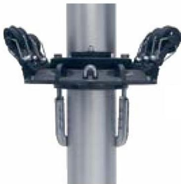
Стяжные стержни препятствуют бегучему такелажу приподнять палубу.
