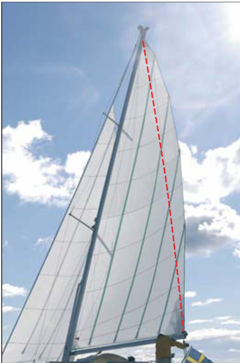
Любой, кто считает, что система закрутки паруса малоэффективна, поскольку она не может обеспечить достаточного серпа (часть паруса, расположенная за прямой, соединяющей углы), теперь будет неправ. Новые мачты Seldén с встроенной системой закрутки предназначены для вертикальных лат и истинного позитивного серпа.
