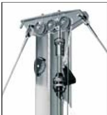
*Мачтовая система закрутки Seldén: Шестеренчатая лебедка привода линя, натянутый профиль обтекателя с липазом, ассиметрично расположенный паз для паруса и запатентованный распределитель нагрузки на фаловом вертлюге. Все эти компоненты делают закрутку простой и быстрой операцией.*
