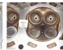
Камера сгорания ПОСЛЕ P.i. применения.
