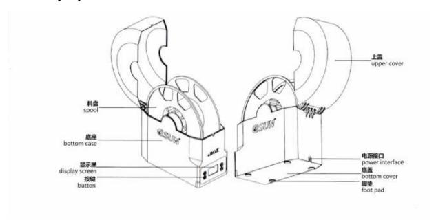
Устройство в рабочем режиме состоит из следующих компонентов и органов управления:
