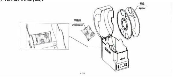
4. Поместите катушку внутрь и протяните филамент через паз. Закройте крышку (направление вытягивания нити из устройства может быть снизу-вверх или сверху-вниз, в зависимости от положения принтера устройства относительно принтера и способа загрузки филамента в принтер).
