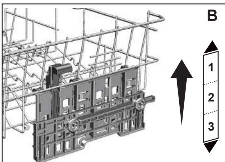
**i** Механизм движения может не работать должным образом, если верхняя корзина перегружена или когда нагрузка неуравновешенна. А в более тяжелых условиях она может перейти на следующую более низкую позицию.
