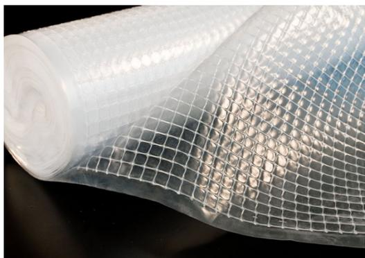
Армированная полиэтиленовая пленка - это долговечное укрывное полотно многоцелевого назначения. Пленка состоит из трехслойного высокотехнологичного материала: основа – армирующая сетка из полимерных нитей, два внешних слоя – светостабилизированная прозрачная пленка. Армированная пленка значительно прочнее обычных однослойных укрывных пленок. При механическом повреждении полотно легко ремонтируется благодаря сетчатой основе, сдерживающей дальнейший разрыв.
