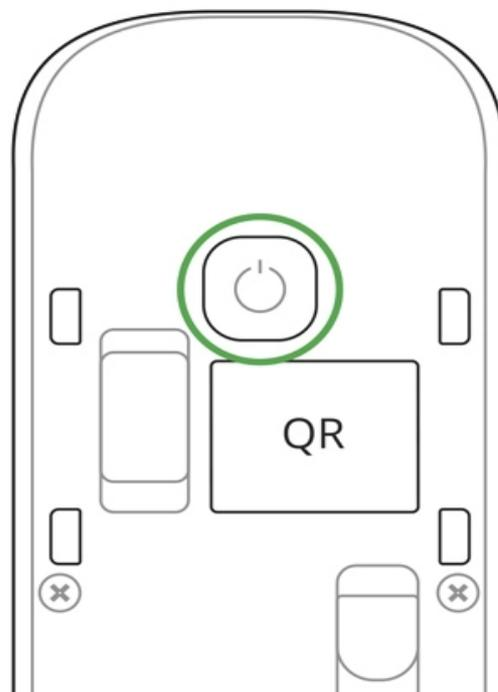
Чтобы произошло обнаружение и сопряжение, устройство должно находиться в зоне действия радиосвязи хаба (на одном охраняемом объекте). Запрос на подключение к хабу передается только в момент включения устройства.
