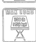
Максимальная нагрузка при использовании обеих столешниц: 350 фунтов [158 кг] при равномерном распределении; 100 фунтов [45 кг] при неравномерном распределении на одну из частей стола
