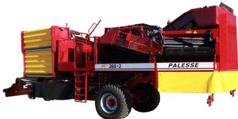
Комбайн двухрядный с боковым подкопом предназначен для уборки картофеля на легких, средних и тяжелых почвах, отделением его от примесей и накопления в бункере с последующей выгрузкой. Комбайн показывает высокую производительность при уборке урожая на больших площадях и востребован в хозяйствах с развитым картофелеводством.
