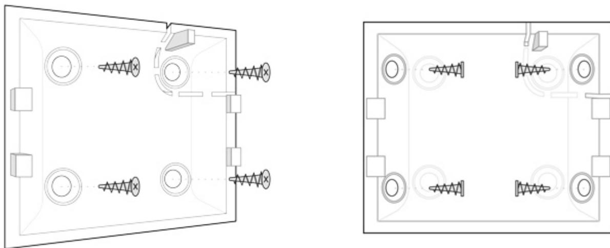
1. Закрепите панель SmartBracket на поверхности комплектными шурупами, используя не менее двух точек фиксации (одна из них – над тампером). Выбрав другие средства крепежа, убедитесь, что они не повреждают и не деформируют панель.
