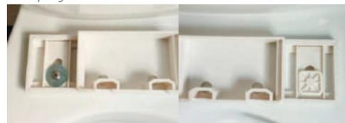
5. Откройте крышку на задней части системы, подключите аккумулятор указанным на рисунке образом, вставьте в устройство, после чего закройте крышку обратно.
