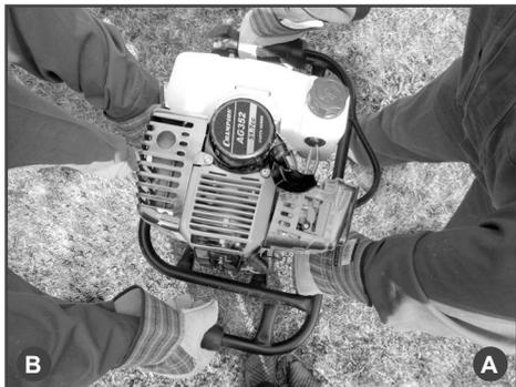
**Рис.10** Положение рук при работе вдвоем
