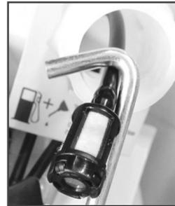
Рис. 12 Извлечение топливного фильтра
