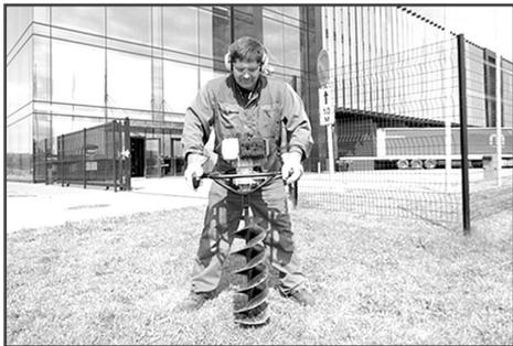
Рис. 8 Положение тела оператора при работе мотобуром
