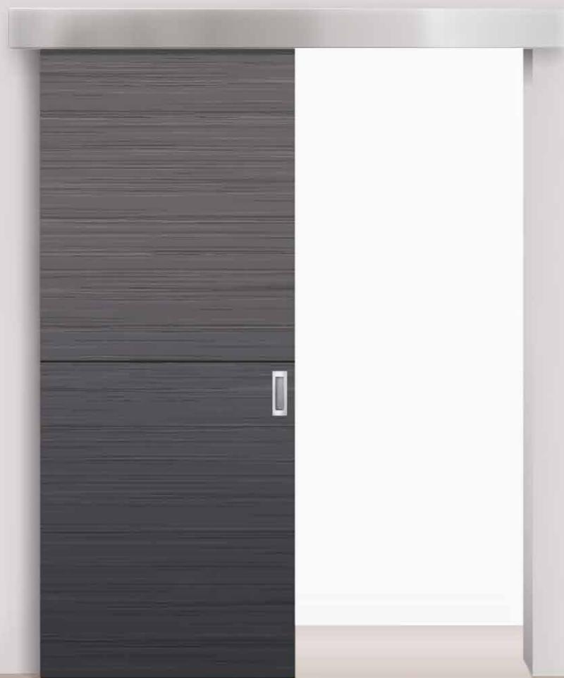
Comfort-PRO STANDART — подвесная роликовая система одностороннего открывания параллельно стене. Полный комплект для установки включает Comfort-PRO SET 1/rollers/80. Comfort-PRO SET 1/rollers/80 с двумя роликами рассчитана для установки на деревянные межкомнатные двери весом до 80 кг, толщиной полотна от 30 мм и шириной от 500 мм. Нейлоновые колеса с подшипниками гарантируют бесшумное скольжение по направляющим. Предусмотрена регулировка полотна относительно пола.
