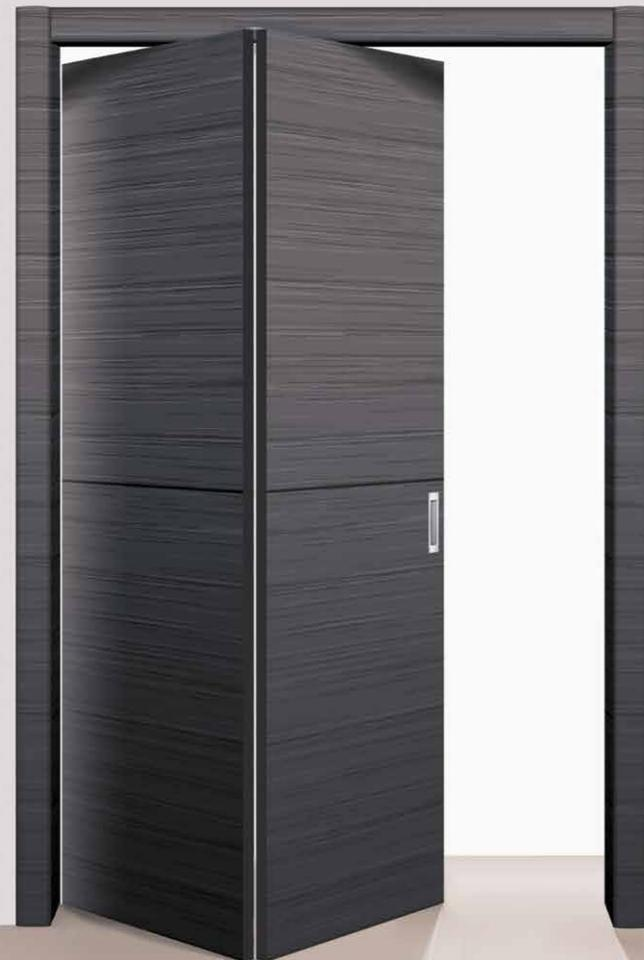
Складная система «книжка» — удачное решение для экономии свободного пространства в помещении. Система Folding предназначена для установки в стандартную дверную коробку на деревянные межкомнатные двери весом до 40 кг и толщиной полотна 30-40 мм. Подходит для правого и левого открывания двери. Универсальный механизм дает возможность для установки на равные или ассиметричные створки по желанию.
