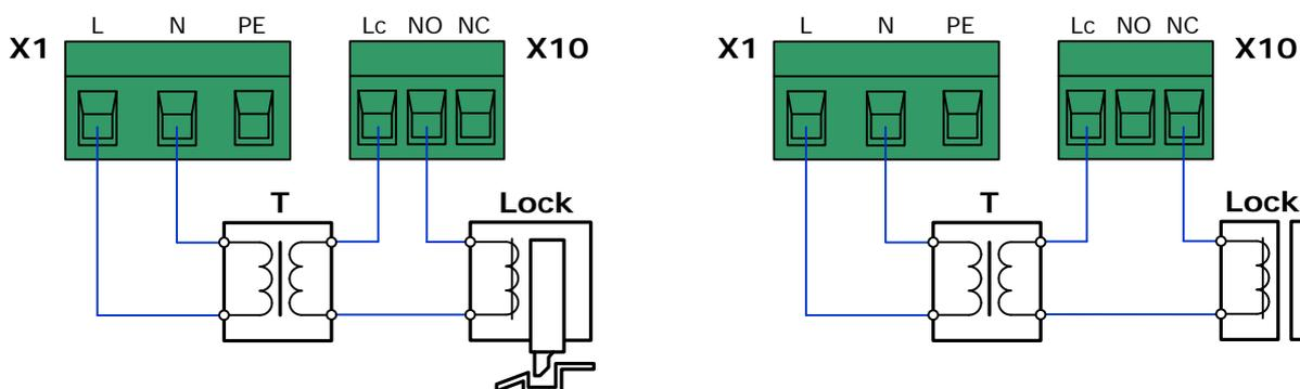
T – источник питания электрического замка (например, трансформатор). Выбирается вместе с моделью электрозамка!
