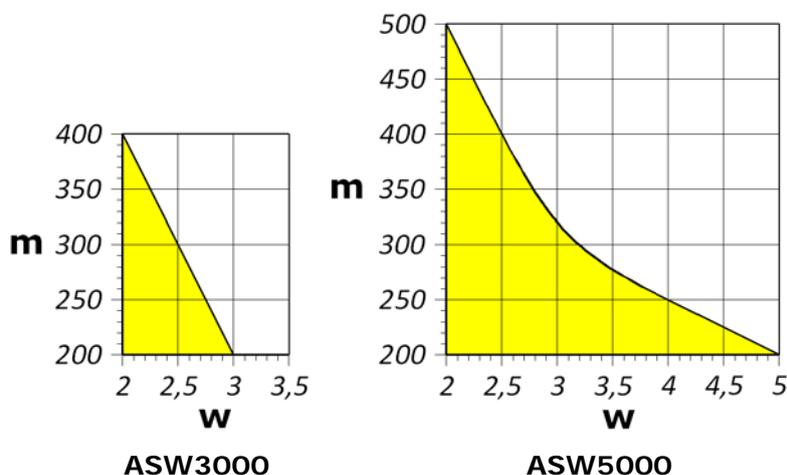
**Рисунок 2.** Ограничение применения: *m* – масса створки ворот (кг), *w* – ширина створки ворот (м). Цветом выделена зона применимости привода.
