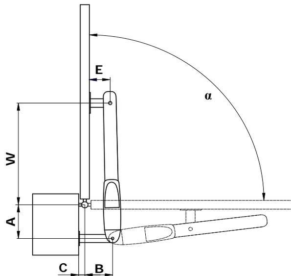
**Рисунок 5.** Монтажная схема при открытии ворот наружу
