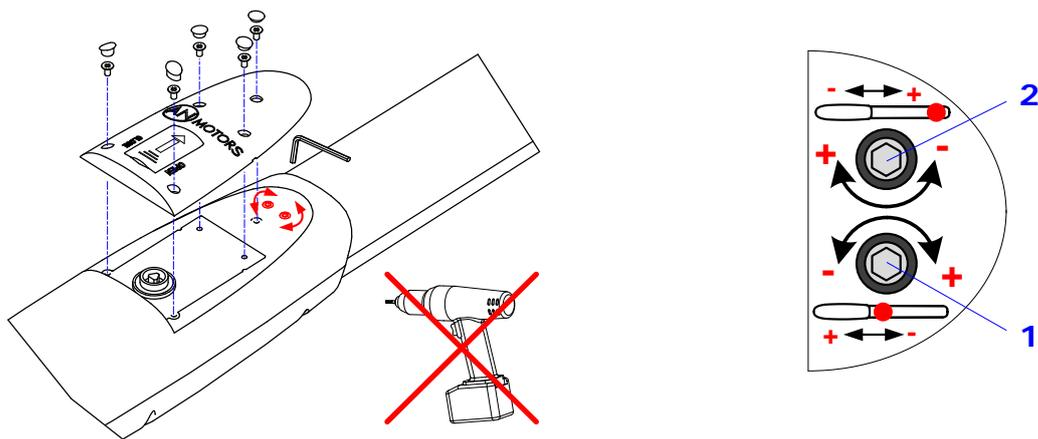
Рисунок 20. Винты регулировки конечных положений
