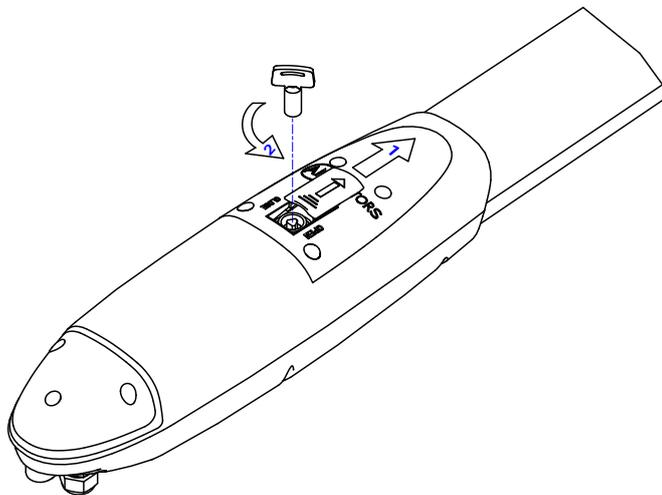
**Рисунок 14.** Ручная разблокировка
