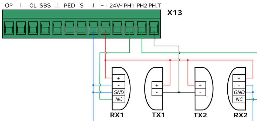
TX1 и RX1 – передатчик и приемник фотоэлементов для безопасности закрытия
