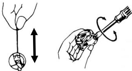
Натяжение нижней нити можно увеличить, слегка поворачивая винт шпульного колпачка вправо (по часовой стрелке). Поворот винта влево (против часовой стрелки) уменьшает натяжение.
