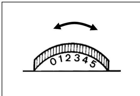
С помощью регулятора ширины стежка вы можете регулировать ширину стежка от 0 до 5.
