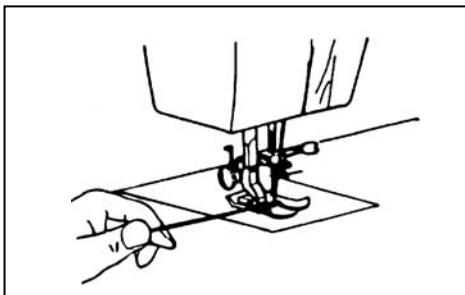
1. Удерживая заправленную верхнюю нить левой рукой, вращайте маховик на себя, чтобы игла опустилась и поднялась вверх. Затем остановите маховик, когда нитепротягиватель будет в крайнем верхнем положении. Слегка потяните за верхнюю нить, чтобы она вытянула нижнюю нить в виде петли.
