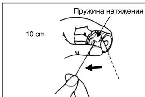
3. Проведите нить через паз и под пружиной натяжения и вытяните примерно 10 см.
