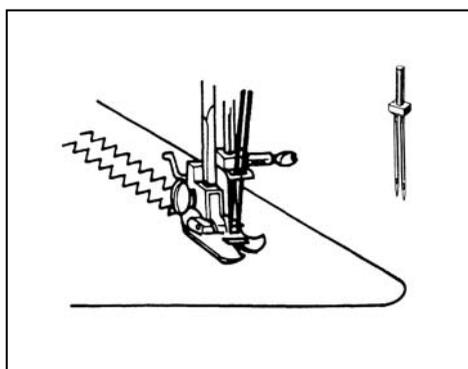
Установите дополнительный кутушечный стержень (В) (приобретается отдельно) в отверстие на задней спинке машины. См стр.5, поз. 4. Установите двойную иглу, сориентировав ее плоской стороной от себя. Заправьте нити по стандартной схеме, проведите обе нити к игле и пропустите каждую через игольное ушко. Ширина стежка не должна превышать значение «3» на диске регулятора ширины, так как это может привести к поломке иглы.
