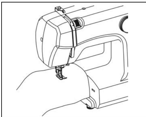
1. Эта швейная машина может быть использована как плоскошвейная, но легко трансформируется для работы в режиме «свободный рукав», для чего необходимо снять часть столика, оставив узкую рукавную платформу.
