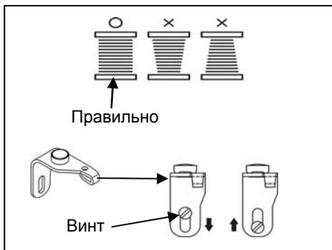
В случае неправильной намотки ослабьте винт регулировки верхней нити и опускайте нитепритягиватель вверх и вниз, пока не будет достигнута сбалансированная намотка.
