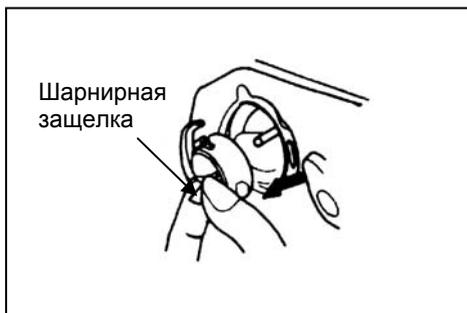
2. Отведите шарнирную защелку шпульного колпачка и извлеките шпульный колпачок из машины.
