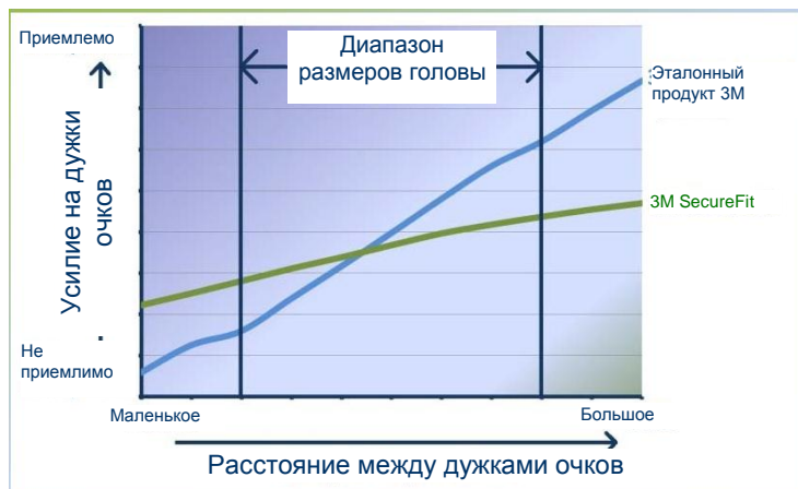
Рис. 7 – Сравнение усилия на дужки/расстояния между дужками для очков SecureFit и эталонного изделия компании 3M
