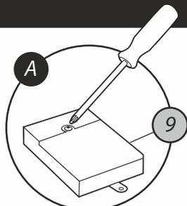
откройте крышку корпуса с помощью отвертки
