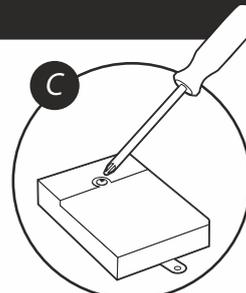
закройте крышку с помощью отвертки
