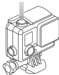
**PRO TIP.** Если включена функция QuikCapture (Быстрая съемка), вы можете включить камеру и мгновенно начать снимать видео или фотографии в режиме замедленной съемки, просто нажав кнопку **Shutter/Select (Спуск затвора/выбор)**. Нажмите для съемки видео, нажмите и удерживайте для фотографирования в режиме замедленной съемки. Дополнительные сведения см. в разделе [QuikCapture \(Быстрая съемка\)](#) (стр. 49).
