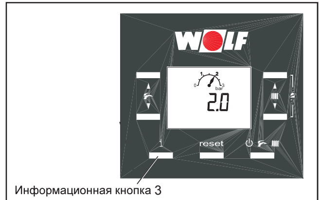
Рисунок: Индикация давления на дисплее системы регулирования
