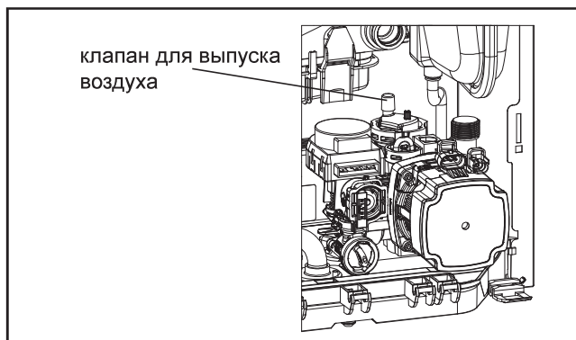
Рисунок: Автоматический клапан для выпуска воздуха на насосе контура отопления
