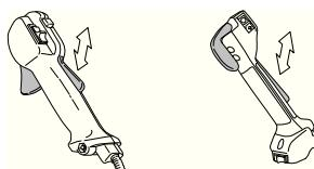
Проверьте, чтобы ручка газа и блокировочный рычаг перемещались свободно и чтобы возвратные пружины работали соответствующим образом.
