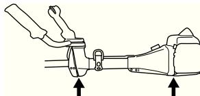
При работе с неправильно намотанной струной или неисправным режущим оборудованием уровень вибрации повышает. См. раздел Режущее оборудование.
