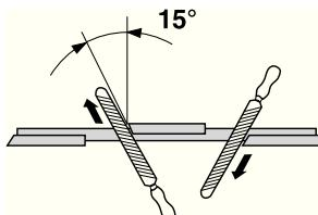
Отрегулируйте разводку. Она должен составлять 1 mm.
