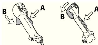
Проверьте, чтобы ручка газа в момент возвращения блокировочного рычага в исходное положение была блокирована на холостом ходу.
