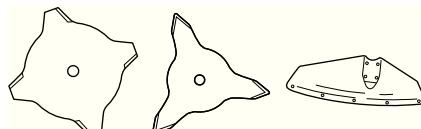
Лезвия для рубки предназначены для выкашивания сильной травы и срезания кустов.
