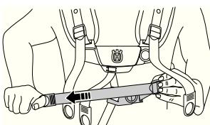
Отрегулируйте высоту крюка для подвешивания согласно инструкции. (При проведении работ по прореживанию леса подвеска должна располагаться прибл. в 10 см. ниже бедер).
