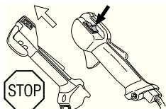
Запустите двигатель и проверьте, чтобы он остановился при переводе выключателя в положение стоп.
