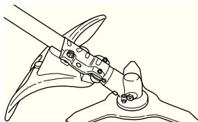
Проверьте, чтобы защита не была повреждена и чтобы на ней не было трещин. Замените защиту, если она была подвержена удару или если на ней есть трещины.
