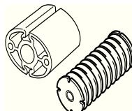
Регулярно проверяйте, чтобы на виброгасящих элементах не было трещин или деформаций. Проверьте, чтобы амортизатор был в целости и хорошо закреплен.
