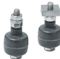
Ролик резиновый изготовлен из некрасящей резины, не оставляет следов на створке. В конструкции ролика предусмотрена нейлоновая втулка скольжения, исключающая шум, повышающая плавность хода и не требующая обслуживания при эксплуатации. Ролики используются совместно с любым из кронштейнов РОЛТЭК, поставляются с разным набором крепежа.
