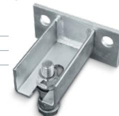
Кронштейн поддерживающий применяется для крепления направляющей для подвесных ворот к несущей конструкции. С помощью кронштейна можно проводить вертикальную и горизонтальную регулировку положения створки ворот относительно проема.
