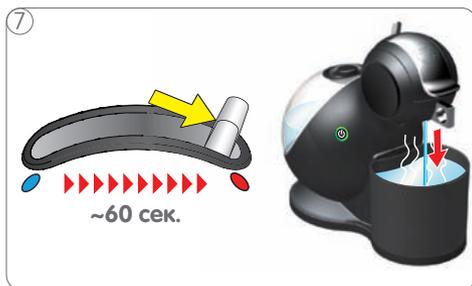
7 Установите рычаг выбора в положение «ГОРЯЧАЯ ВОДА». Машина начнет промывку.
