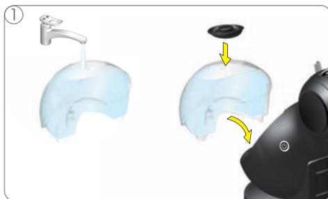
1 При первом использовании промойте емкость для воды. Наполните емкость для воды свежей питьевой водой. Наденьте крышку и вставьте емкость для воды в машину.
