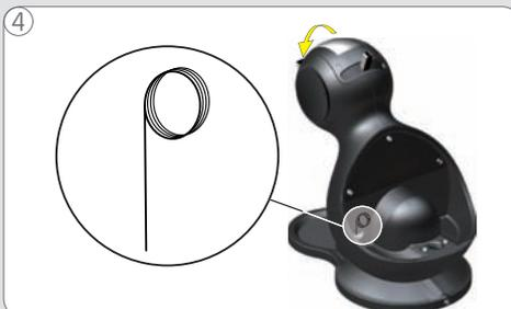
Снимите емкость для воды и достаньте иголку для очистки. Закройте блокирующую рукоятку.
