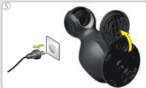
Отсоедините машину от сети питания. Для лучшего доступа к инжектору наклоните машину.
