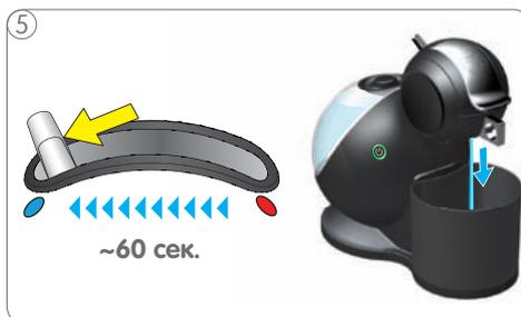
5 Установите рычаг выбора в положение «ХОЛОДНАЯ ВОДА». Машина начнет промывку.
