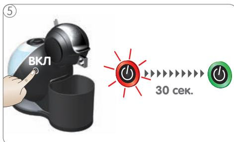
5 Включите машину. Кнопка включения начнет мигать красным цветом, пока машина нагревается около 30 секунд. После этого кнопка включения постоянно горит зеленым цветом и машина готова.
