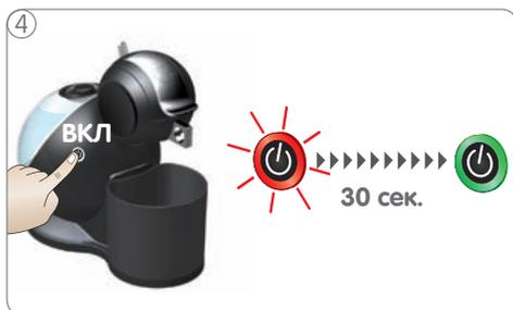
4 Включите машину. Кнопка включения начнет мигать красным цветом, пока машина нагревается около 30 секунд. После этого кнопка включения постоянно горит зеленым цветом и машина готова.
