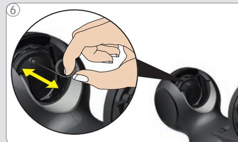
Разблокируйте инжектор с помощью иголки для очистки.
