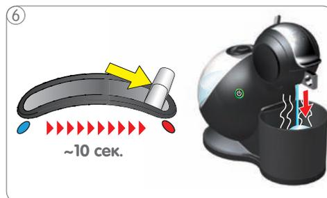
6 Установите рычаг выбора в положение «ГОРЯЧАЯ ВОДА». Машина начнет промывку.
