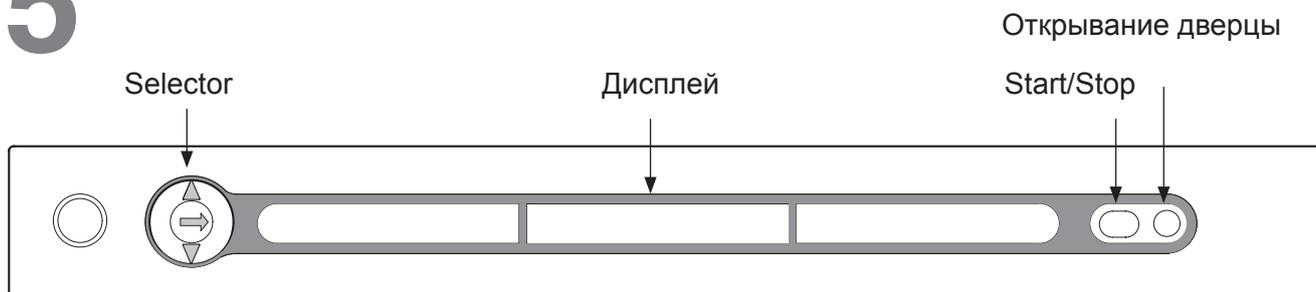
Программу можно выбрать, вращая переключатель программ. На дисплее подсвечивается название выбранной программы и отображается время завершения ее выполнения. Запустите выполнение программы, нажав кнопку Start/Stop, либо нажмите кнопку в центре переключателя программ для выбора дополнительных опций.
