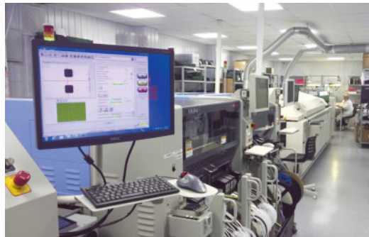
Линия поверхностного монтажа электронных компонентов
