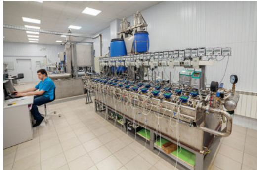
Метрологическая лаборатория оборудована проливными установками для поверки счетчиков воды и тепла Ду15-Ду200
