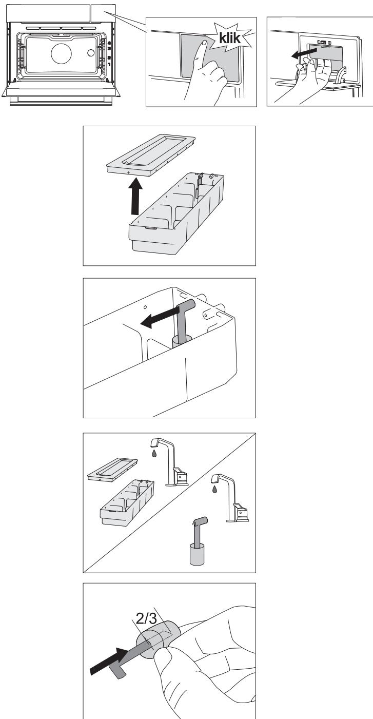
**1** Снимите крышку резервуара.
