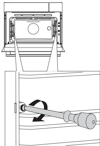
**1** Открутите винты с помощью отвертки.
