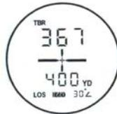
Для владельцев ружей на дисплее может также отображаться информация о регулировке или удержании. Могут быть выбраны следующие настройки: MOA отображает корректировку в угловых минутах, HOLD (удержание) отображает дюймы или сантиметры для удерживания точки попадания и BAS (система баллистического прицеливания) отображает эквивалентный диапазон, в котором следует использовать визирные сетки для баллистической наводки Ballistics Aiming System™ от компании Leupold, или
