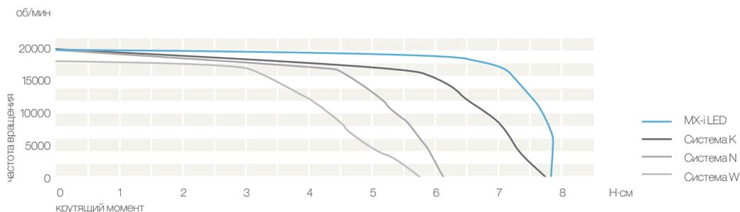
Микро мотор MX-i LED в первую очередь образец отличного качества. И на высоких, и на низких оборотах новый мотор очень удобен в работе. Высокий крутящий момент делает микро мотор MX-i LED самым мощным из представленных на рынке. В зависимости от необходимого крутящего момента мощность двигателя регулируется и стабилизируется электронной системой. Таким образом, в течение всей операции частота вращения поддерживается на постоянном уровне.
