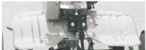
7. Прикрепите нижнюю опорную раму для крыльев.
