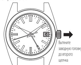
④ Поворачивайте заводную головку против часовей стрелки (в направлении 6 часов), чтобы повернуть 24-часовую и минутную стрелки против часовей стрелки и установить их на текущее время. Установите минутную стрелку немного раньше желаемого времени, а затем медленно переместите ее вперед до нужной отметки.
