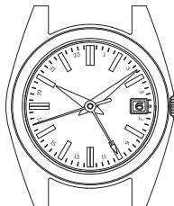
**<Режим 2>** Использование 24-часовой стрелки, для указания времени в различных часовых поясах.
