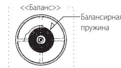
Металлы расширяются и сжимаются в зависимости от температуры. Эта характеристика всех металлов также относится и к балансирующей пружине. И это влияет на точность механических часов.
