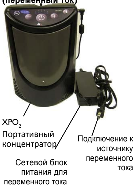
РИС. 6.7 Обеспечение XPO_2 энергией
