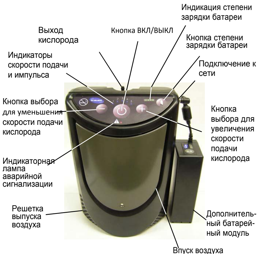
ИЗОБРАЖЕНИЕ 5.1 ЭЛЕМЕНТЫ ИНДИКАЦИИ И УПРАВЛЕНИЯ КИСЛОРОДНОГО КОНЦЕНТРАТОРА XPO 2
