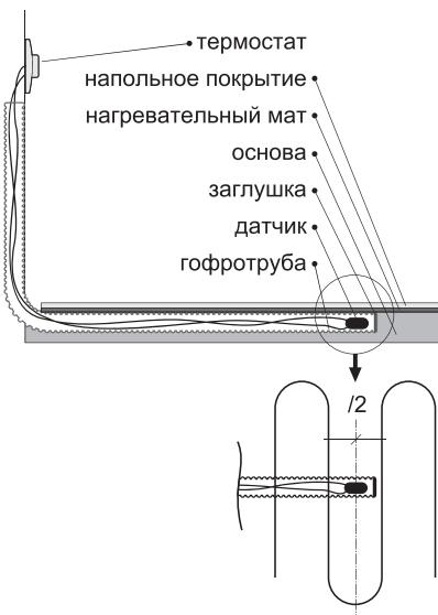
**греющий кабель.** Зафиксируйте разложенный нагревательный мат строительным скотчем, с помощью kleящего пистолета и т.д. Проводить укладку матов следует при температуре выше +5°C.
