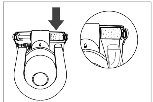
Пустую катушку справа выньте и переставьте в посадочные углубления в левую часть механизма.
