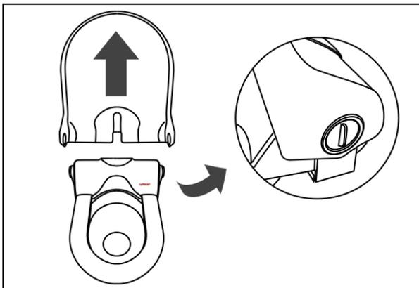
Снимите верхнюю крышку, потянув в стороны в месте крепления к корпусу устройства
