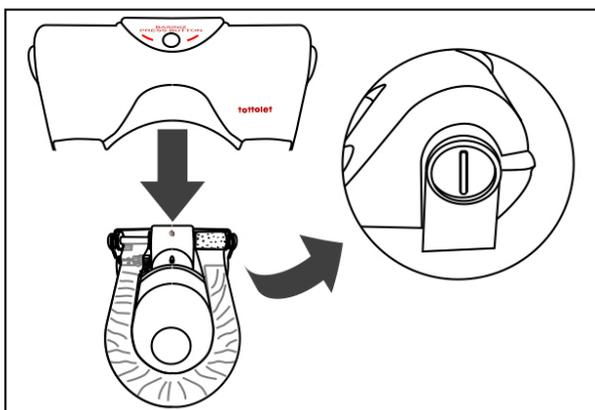
Установите крышку механизма на корпус и поверните замки-фиксаторы до упора.
