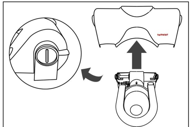
Поверните замки-фиксаторы и снимите крышку механизма
