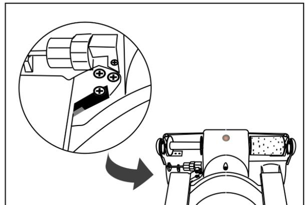
Аккуратно выньте старый нож и замените его новым. Закрепите нож винтами при помощи отвертки.
