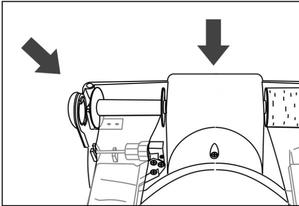
Надрежьте край рулона, протянув его через лезвие ножа. Закрепите конец рулона на пустой приемной катушке. Нажмите пусковую кнопку для запуска механизма. Убедитесь, что рулон наматывается на приемную катушку.
