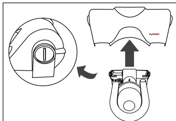
Поверните замки-фиксаторы и снимите крышку механизма
