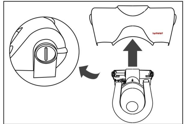
Поверните замки-фиксаторы и снимите крышку механизма
