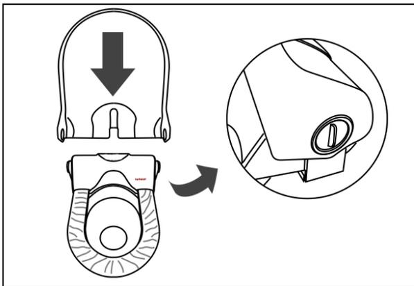
Закрепите крышку устройства на корпусе механизма, продев замки-фиксаторы в отверстия на крышке.
