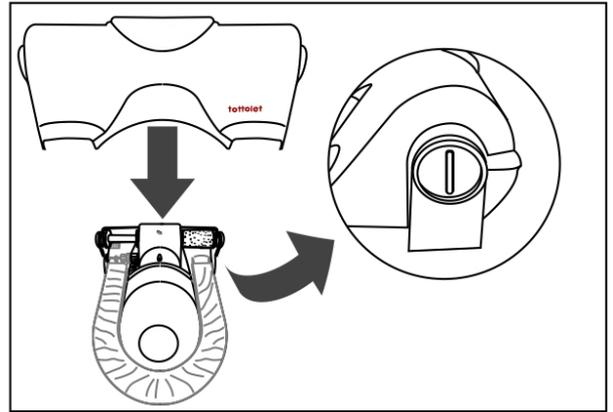
Установите крышку механизма на корпус и поверните замки-фиксаторы до упора.
