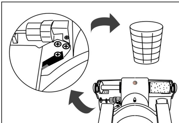
Нож в красном пластиковом корпусе находится возле левого конца сиденья. Открутите крепящие нож винты при помощи отвертки.
