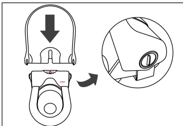
При помощи винтов крепежа установите и прочно закрепите на унитазе монтажную рамку
