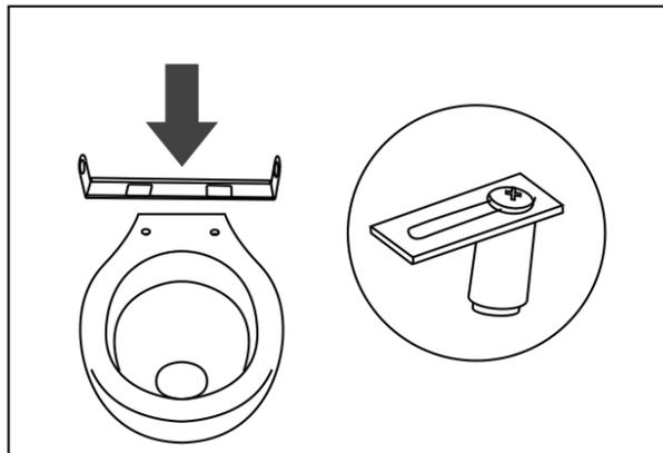
При помощи винтов крепежа установите и прочно закрепите на унитазе монтажную рамку
