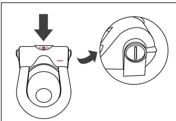
Корпус устройства вставьте в отверстия по бокам монтажной рамки и поверните замки-фиксаторы до упора
