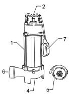
Насос (1) представляет собой моноблочный агрегат, корпус которого разделен на гидравлическую часть и электродвигатель. Однофазный асинхронный электродвигатель с пусковым конденсатором размещен в закрытом от попадания жидкости кожухе из нержавеющей стали. Для защиты двигателя от перегрева в обмотку статора встроено тепловое реле,
